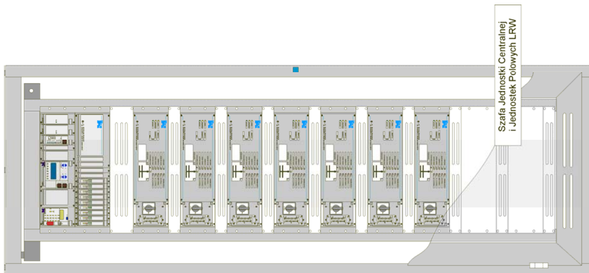
Rys. 6. Automatyka LRW całej rozdzielni umieszczona w jednej szafie.
